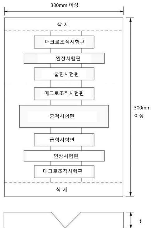
그림 2.1.16 용접보수절차 시험편
