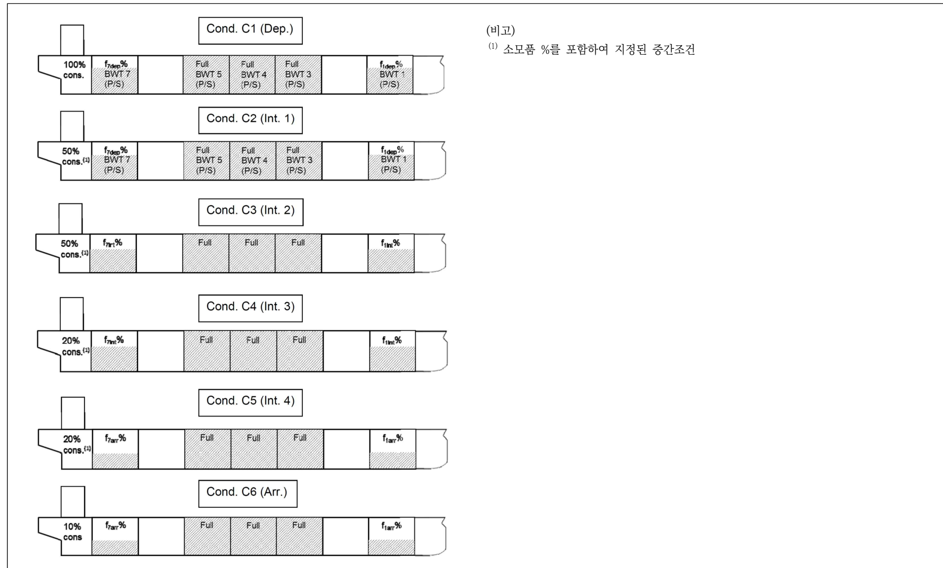
그림 7(a) 평형수 항해중 No.1 (P/S) 평형수 탱크와 No.7 (P/S) 평형수 탱크 모두 부분 적재를 하는 광석운반선의 하중조건 - Case C
