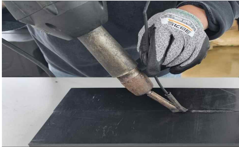
그림 3-2 고온 가스 String bead 용접
