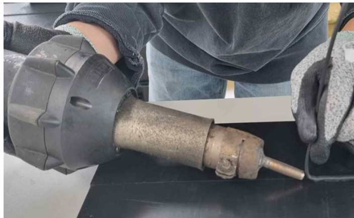
그림 3-1 용접봉과 분리된 토치를 이용한 고온 가스 용접
